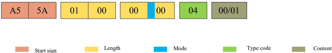
FIG 14 YDLIDAR G4 LOW POWER CONSUMPTION QUERY MESSAGE
